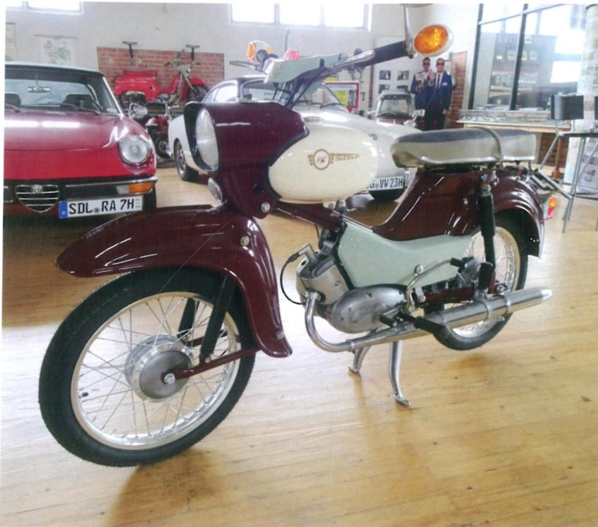
Der Simson SR 4-2 „Star“ ist ein zweiseitiges Kleinkraftrad. Von 1964 bis 1968 hatte das Modell die Bezeichnung „SR402, ab 1968 bis 1975 SR4-2/1“. Auf Grund einer Ausnahmeregelung kann der „Star“ trotz einer Höchstgeschwindigkeit von 60 km/h als Kleinkraftrad mit einem Versicherungskennzeichen zulassungsfrei gefahren werden.
